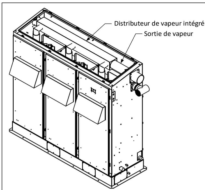
Illustration 15 - Boîtier extérieur avec une sortie de vapeur
