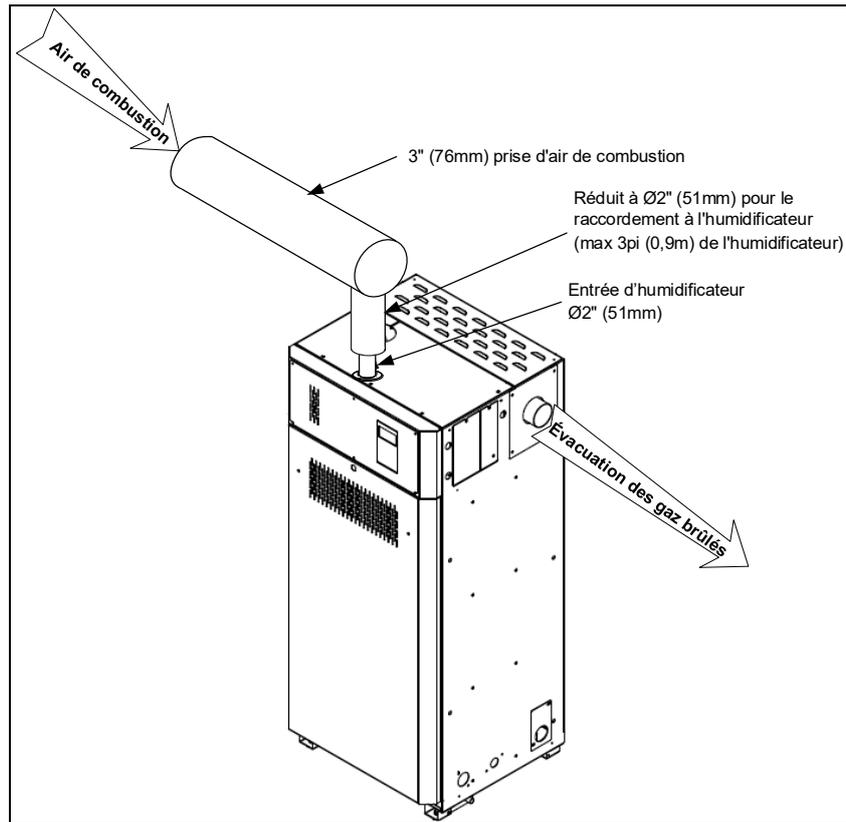
Illustration 34 - Air de combustion par tuyau d'admission (1 module)
