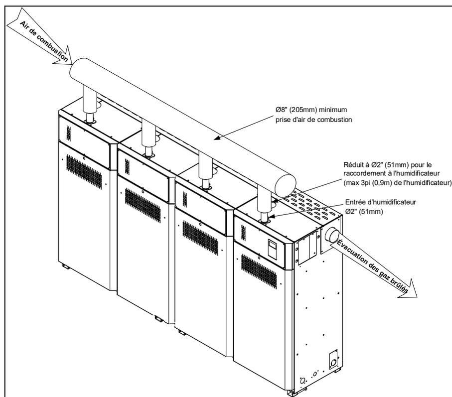
Illustration 37 - Air de combustion par tuyau d'admission (4 modules)
