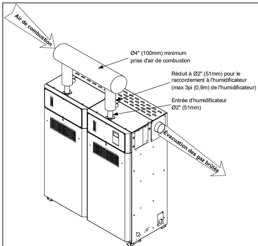
Illustration 35 - Air de combustion par tuyau d'admission (2 modules)
