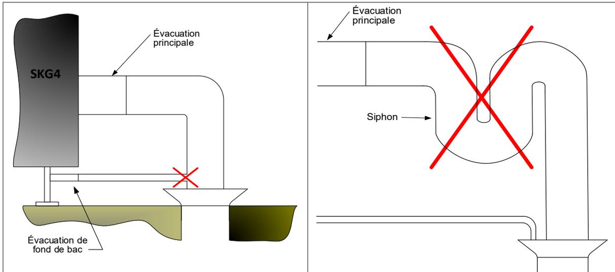
Illustration 30 - Raccordement d'évacuation d'eau : installation incorrecte
