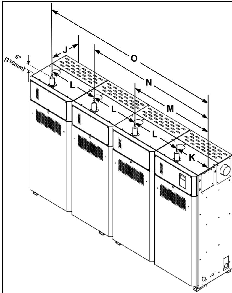
Illustration 5 - Dimensions de tuyaux d'admission d'air de combustion
