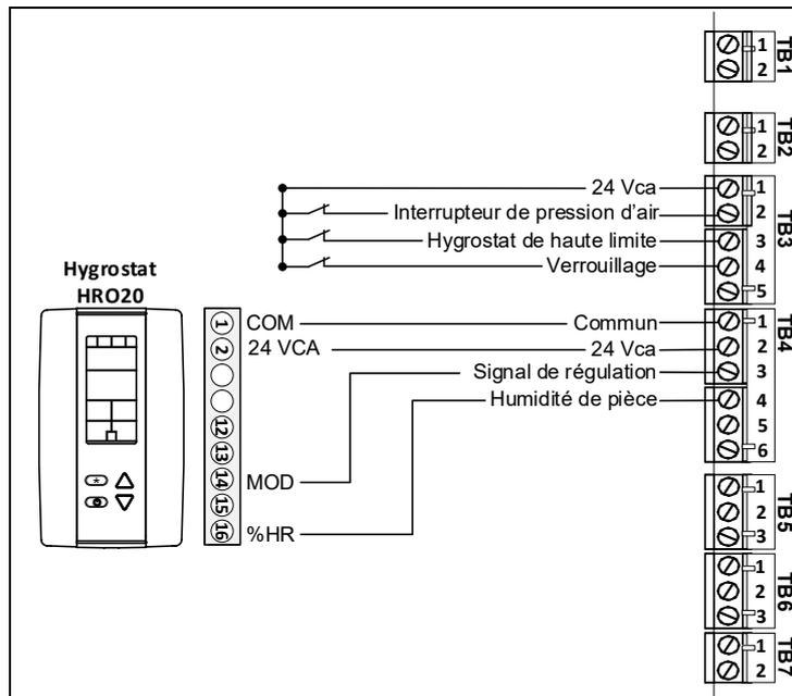
Illustration 42 - Signal de contrôle d'un hygrostat HRO20
