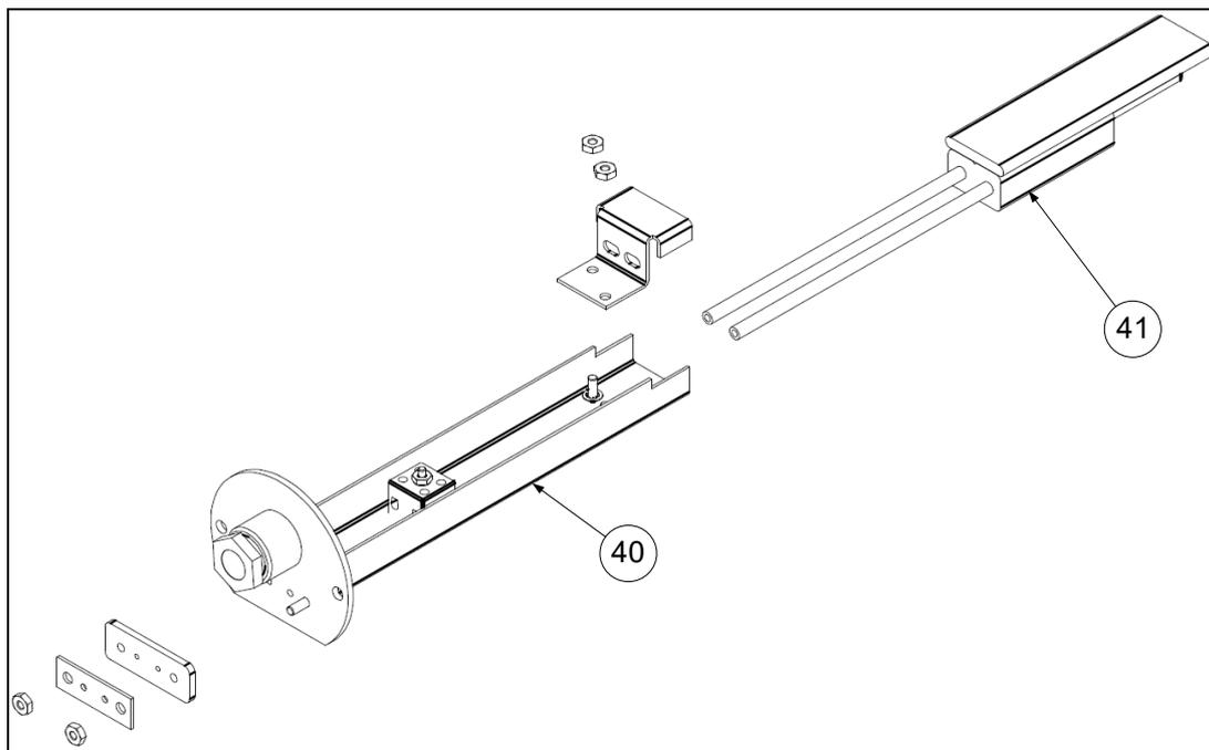
Illustration 55 - Vue explosée de l'assemblage de l'allumeur
