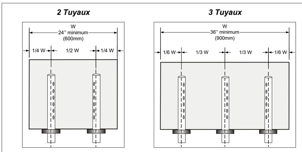
Illustration 18 - Emplacement de tuyaux : conduit vertical
