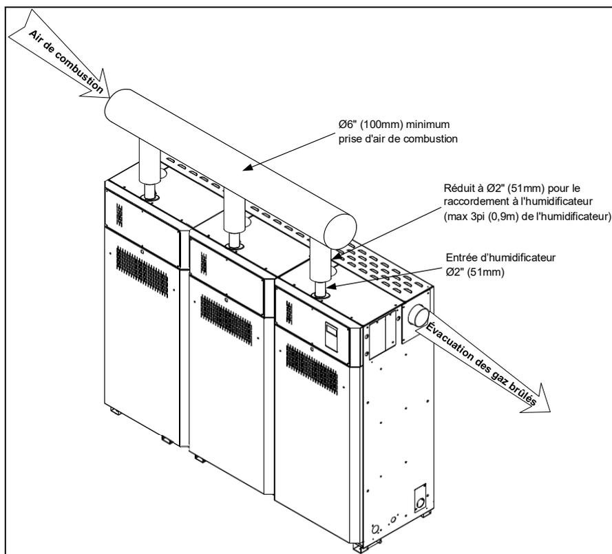
Illustration 36 - Air de combustion par tuyau d'admission (3 modules)
