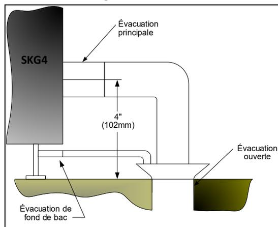
Illustration 29 - Raccordement d'évacuation d'eau : installation correcte
