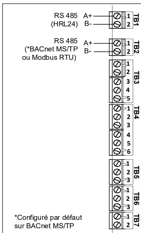
Illustration 46 - Connexions au réseau de communication
