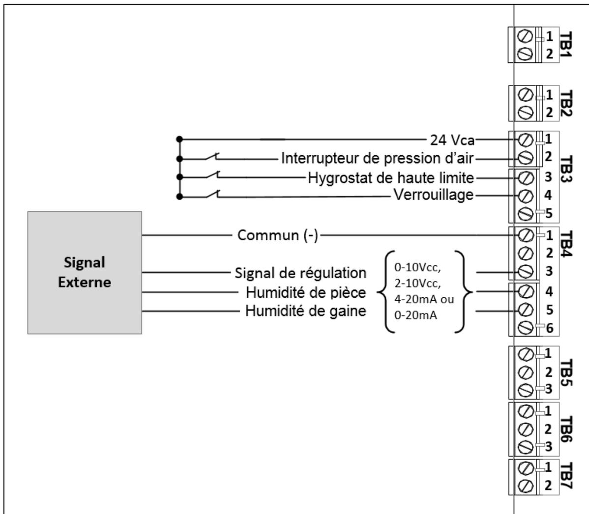
Illustration 45 - Signal de contrôle d'un appareil externe
